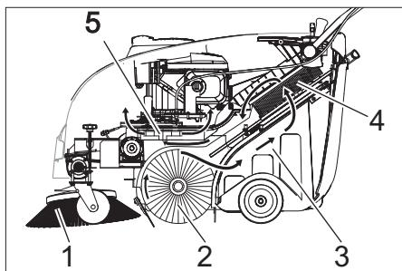
Подметающая машина работает по принципу набрасывания.
